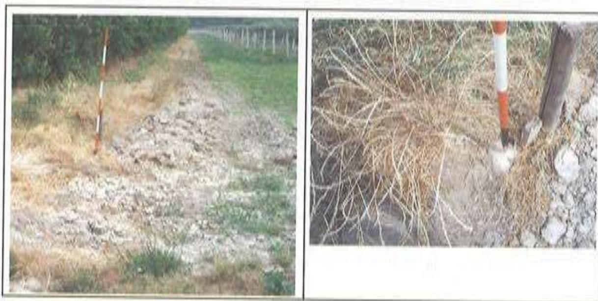
Termine mantenuto e con assegnato RA. Si noti le due foto (generale e particolare) evidenzianti la zona e la forma del termine. Importante la presenza di indicazione del cippo nella foto (palina): potrebbe ovviamente essere sostituito da segno grafico applicato sulla foto
